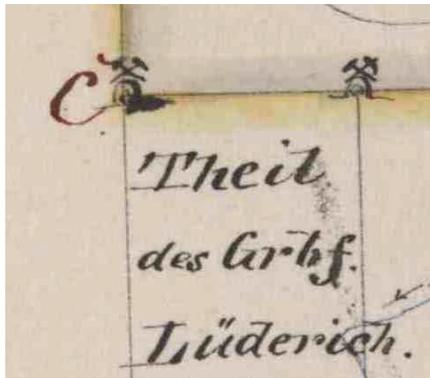
Abb. 5: Ausschnitt aus dem Consolidationsriss mit den darin eingetragenen Lochsteinen an der Feldesgrenze.
