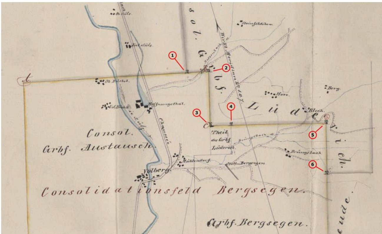
Abb. 4: Ausschnitt aus dem Consolidations-Riss vom Dezember 1870. An der gemeinsamen Grenze zwischen dem Grubenfeld Lüderich und den Feldern Austausch und Bergsegen sind 6 Lochsteine eingetragen. (Bez.-Reg. Arnsberg, B-Akte 9211)
